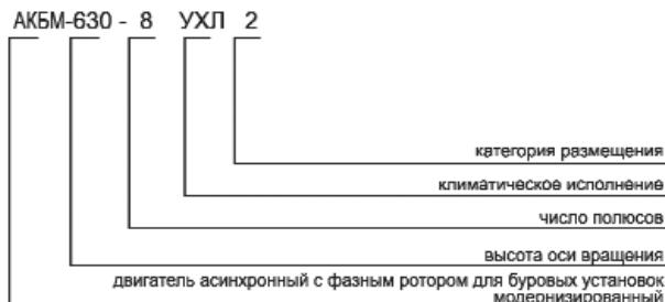
Электродвигатели асинхронные с фазным ротором буровые предназначены для привода лебедок буровых установок. Двигатели работают от сети переменного тока частотой 50 Гц, напряжением 6000 В.
