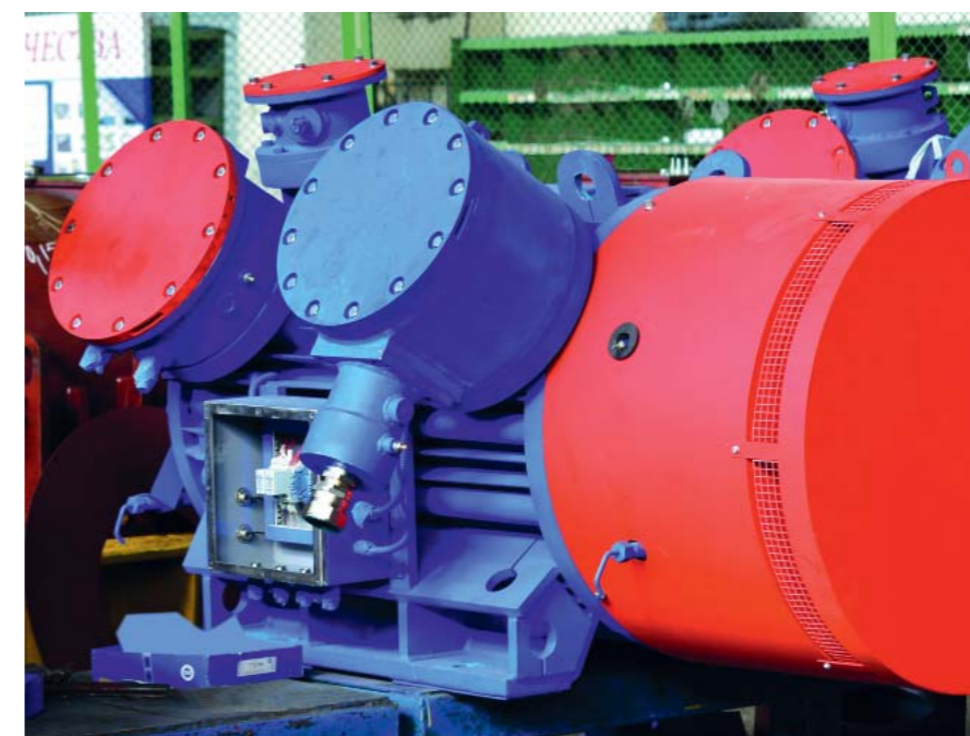
ФОТО 2. Взрывозащищенный электродвигатель с повышенным КПД и сниженным уровнем шума
