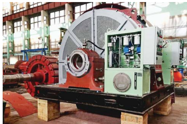
Фото 7. Гидрогенератор для Барсучковской малой гидроэлектростанции
