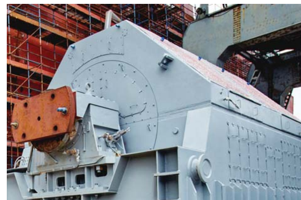
Фото 2. Гребной электродвигатель для новейших атомных ледоколов – гигант массой 300 тонн
