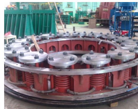
«ЛЭЗ», Санкт-Петербург: сборка и испытания подпятника на гидравлическом опирании
