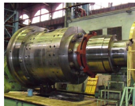
Изготовление комплекта линии вала гидроагрегата на ЗАО «Энергомаш» (Екатеринбург) – «Уралэлектротяжмаш». Финишная операция
