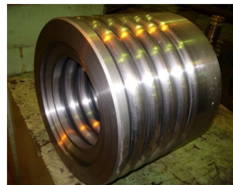
Гидравлическая камера подпятника, которая делает его более надежным в части скрадывания вибраций, а также существенно снижает эксплуатационные расходы
