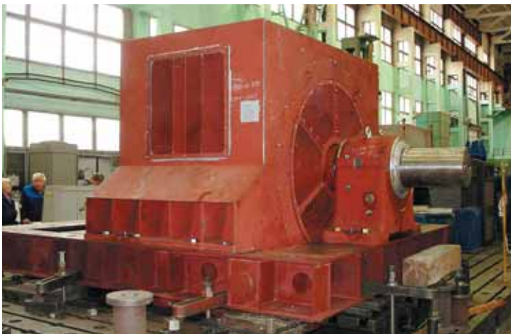
Двигатель АС на испытательном стенде «ЛЭЗа» перед отправкой на шахту «Воргашорская-2»
